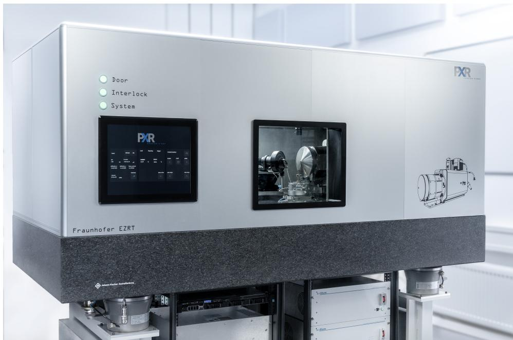
**Kompaktes Stand-alone-Design für einfache Integration in Ihre Laborumgebung. Das »ntCT«-System bietet eine einzigartige Lösung für hochauflösende Messungen, die den etablierten industriellen Mikro-CT-Scannern weit voraus ist, indem es die neuesten Entwicklungen aus der Röntgenforschung anwendet. © Fraunhofer IIS**
