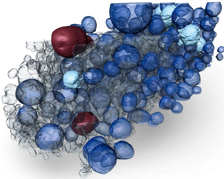
**3D-Analyse mit mikroskopischer Auflösung: Eine beispielhafte Anwendung ist die hier gezeigte Qualitätskontrolle und Schadensanalyse von Li-Elektroden für die neuartige Batterieforschung mit einer Voxel-Probenahme von 140 Nanometern. © Fraunhofer IIS**
